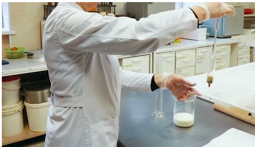
12- сурет – Сүттің тығыздығын ареометрлік әдіспен өлшеу
