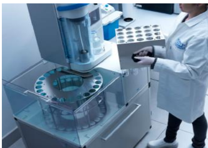
13 - сурет – Кьельдаль әдісімен сүттегі ақуыз мөлшерін анықтау
