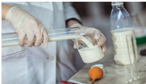
11 - сурет – Сүт қышқылдылығын титрлеу әдісімен анықтау
